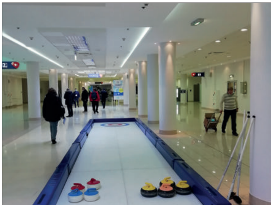
▼ В холле выставочного павильона была установлена дорожка для керлинга, «лед» которой изготовлен из сверхвысокомолекулярного полиэтилена.
