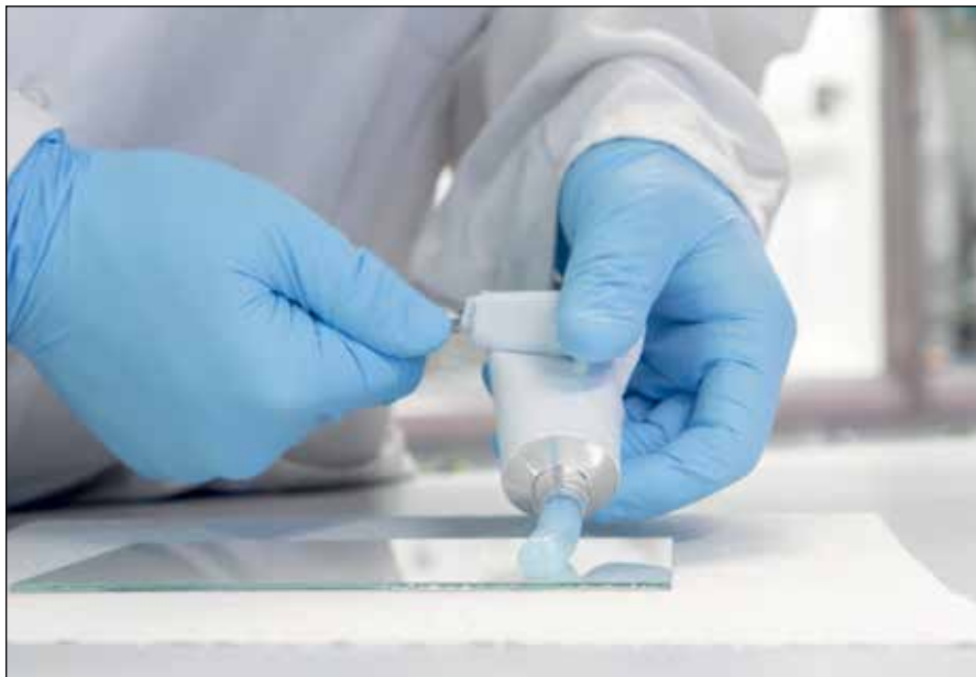
Промышленные клеи, в состав которых входит пирогенная двуокись кремния HDK H21, не стекают по наклонным или изогнутым склеиваемым поверхностям.
