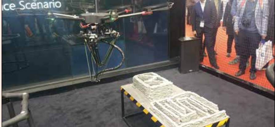
▲ Дрон по имени «летающий слон» от китайской DediBot более не ограничен размерами области печати и может создать сооружение любого размера. Аккумулятора дрона хватает на несколько часов работы.
