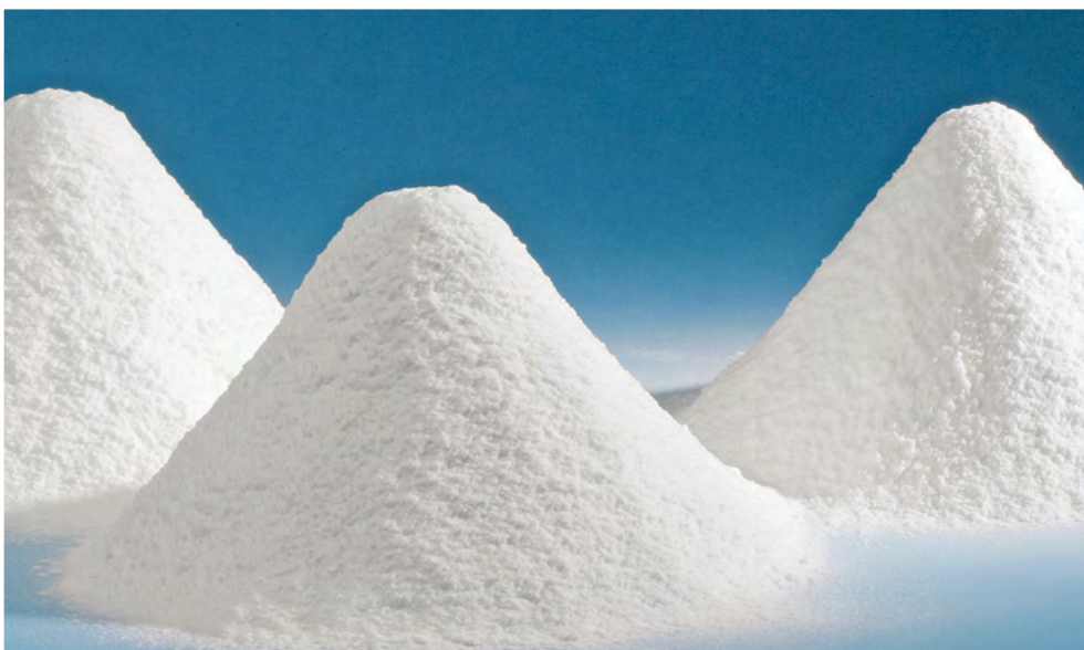
Стеклянные микросферы изготовлены из натрийборосиликатного стекла.
