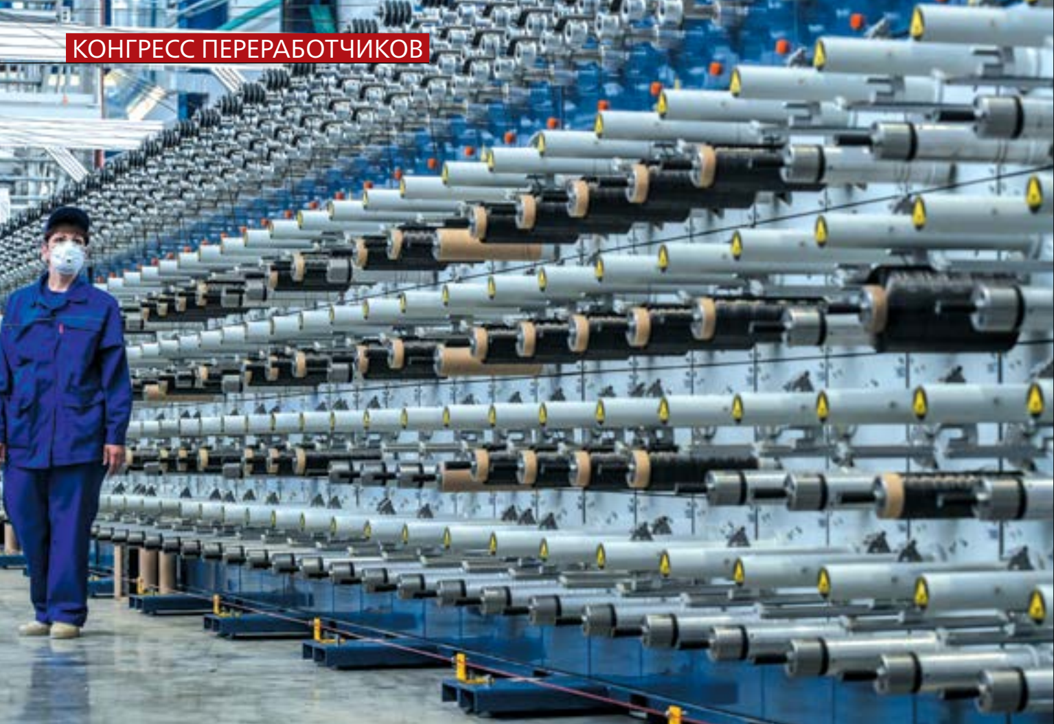
Производство углеродного волокна мощностью 1,5 тыс. тонн на ООО «Алабуга-Волокно».
