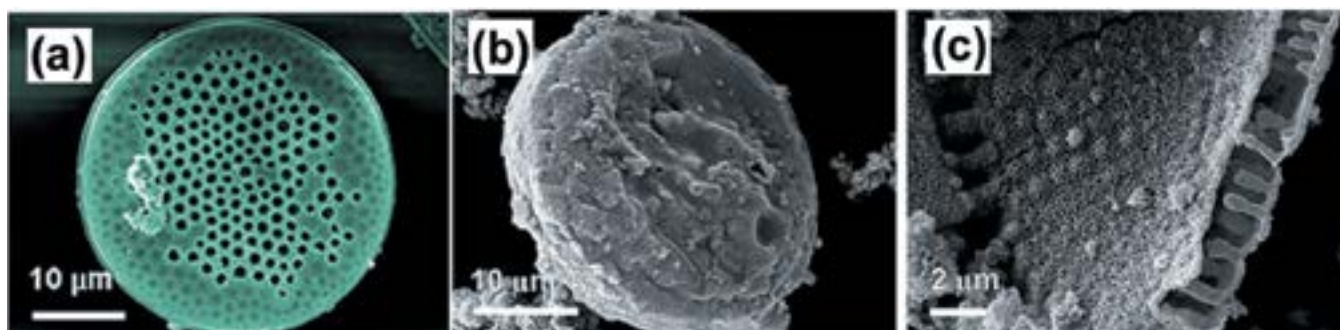
Структура диатомита под электронным микроскопом.
