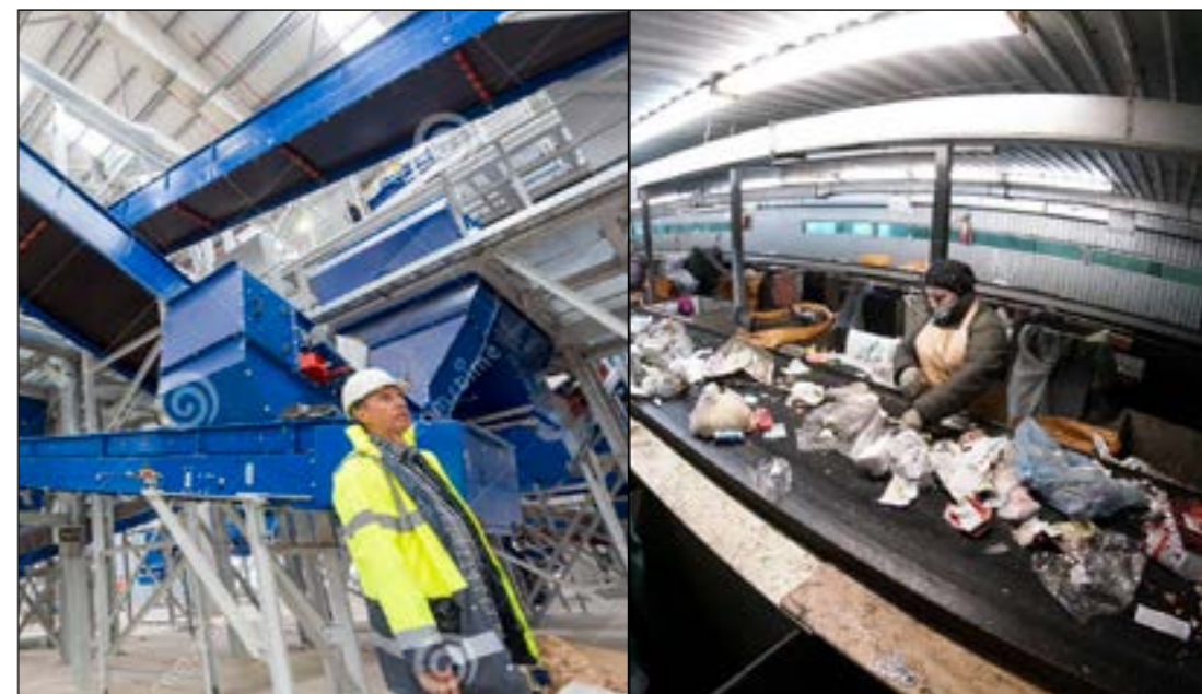
Ключевое различие системы переработки в РФ и ЕС — в степени автоматизации процесса сортировки мусора. Слева — европейское, справа — российское предприятие по переработке ТБО.
