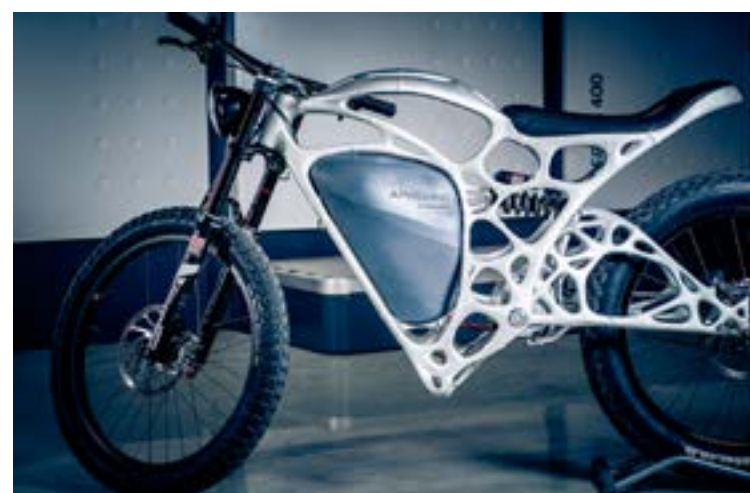
Ультралегкая и сверхпрочная рама мотоцикла полностью напечатана на 3D-принтере из нового материала на основе алюминия.
