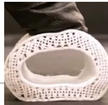
Исследователи Северо-Западного университета (США) разработали полимерную композицию для печати гибкой пористой структуры с внешним контуром заменяемого костного дефекта. Использование «нерастворимого» имплантата предыдущего поколения у детей невозможно: по мере роста ребенок будет обречен на страшные муки, ему будут нужны все новые и новые операции.
