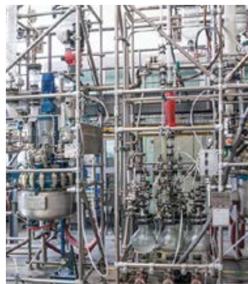
Пилотная установка по отработке процессов нефтехимического синтеза НИОСТА.
