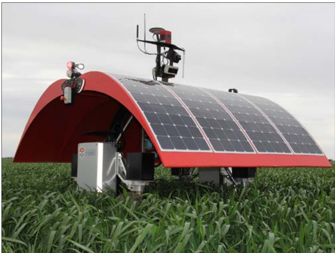
Австралийский сельскохозяйственный робот на солнечных батареях Ladybird (божья коровка) сажает растения и собирает урожай при помощи развитого манипулятора.
