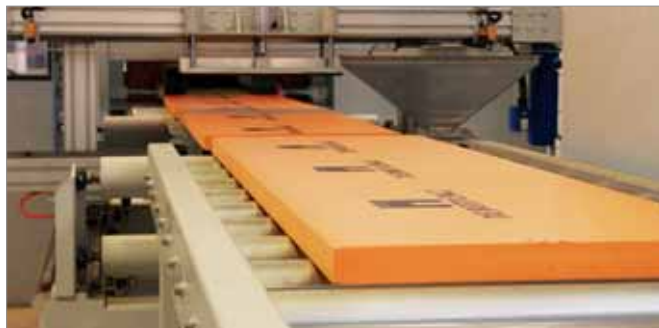
Линия по выпуску теплоизоляционных плит
