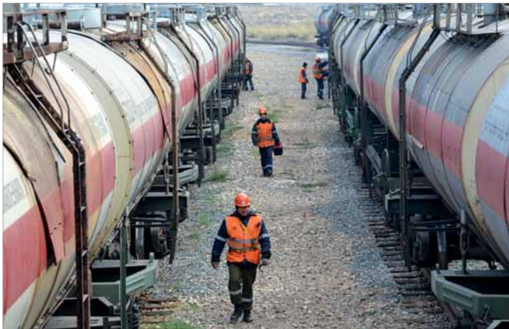
Осмотр и дефектовка цистерн на путях станции астраханского филиала ООО «Газпромтранс»
