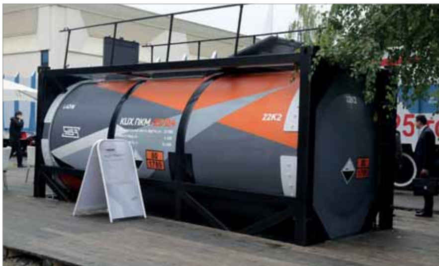
Корпорация «Уралвагонзавод» в этом году представила инновационный танк-контейнер из композиционных материалов для перевозки агрессивной химии
