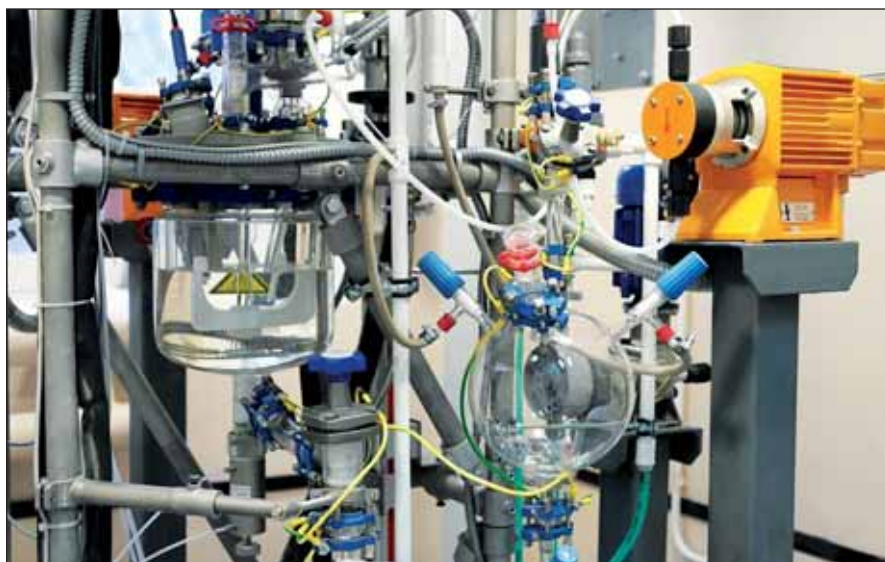
Реакторный узел с реактором объемом 5 л
