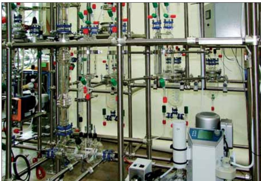
Установка периодической и непрерывной дистилляции
