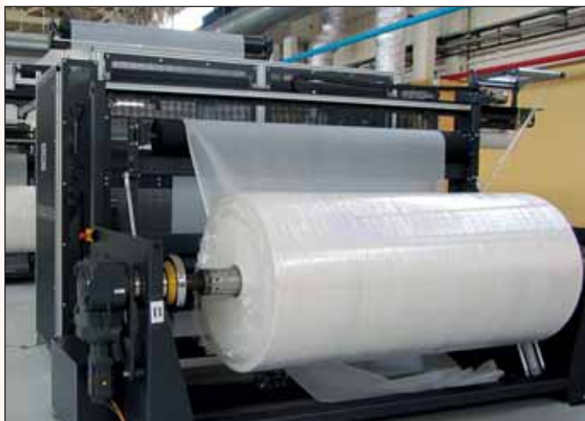
Новая линия по выпуску армирующей сетки из полиэфирных нитей, г. Кириши (Ленинградская область)
