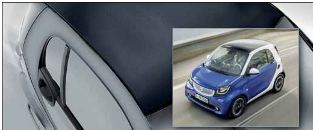
Пеноматериалы из Elastoflex E применяются для нового типа легкой крыши автомобиля Smart Fortwo
