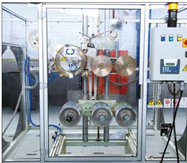
На производстве установлено самое современное финское оборудование, которое позволяет выпускать в год до 600 км трубы различного диаметра
