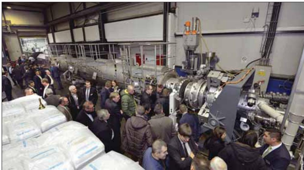
Демонстрация коэкструзионной линии общей производительности 1500 кг/час, производство 4-х-слойной полиолефиновой трубы
