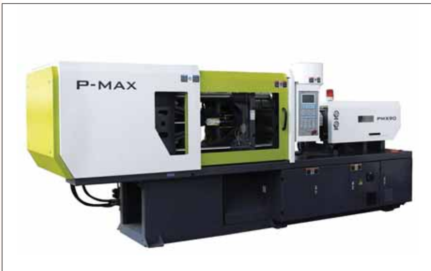
Компания «Полимермакс» представила энергосберегающий термопластавтомат P-MAX с усилием смыкания 140 т снабженный сервоприводом
