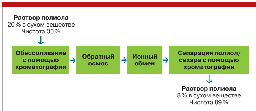
Рис. 7. Схема промышленной очистки растворов многоатомных спиртов
