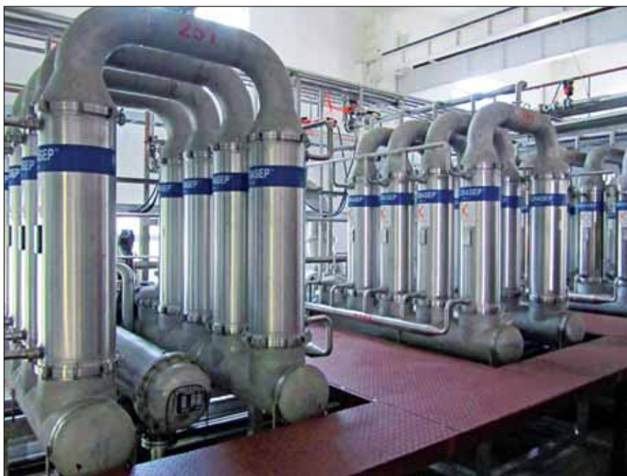
Рис. 3. Промышленная установка для тангенциальной фильтрации (с использованием керамических мембран Kerasep®)
