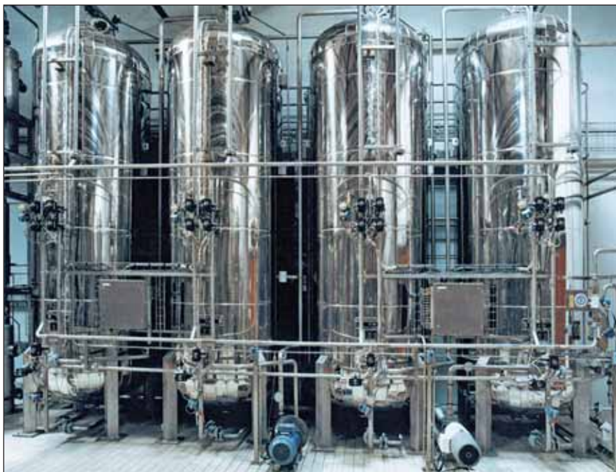
Рис. 5. Хроматография с последовательным псевдодвижущимся слоем (SSMB хроматография, патент Applexion®)
