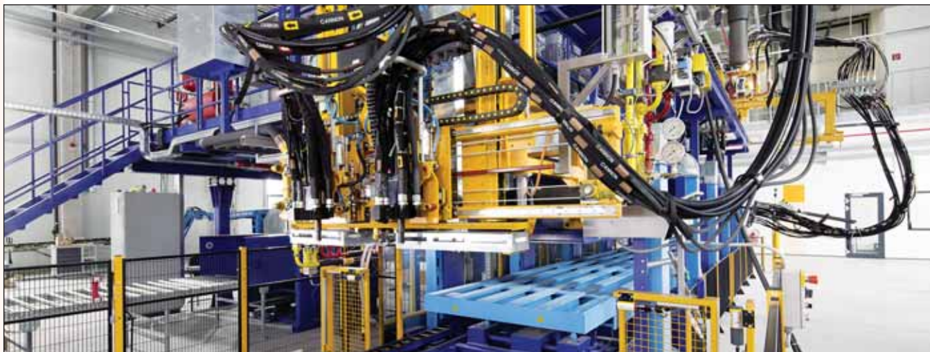
Пилотная технологическая линия BASF для производства изоляционных панелей из полиуретана, г. Лемфёрде (Германия)
