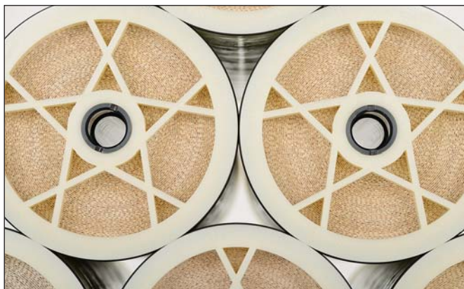
Мембраны Lewabrane RO S для опреснения морской воды
