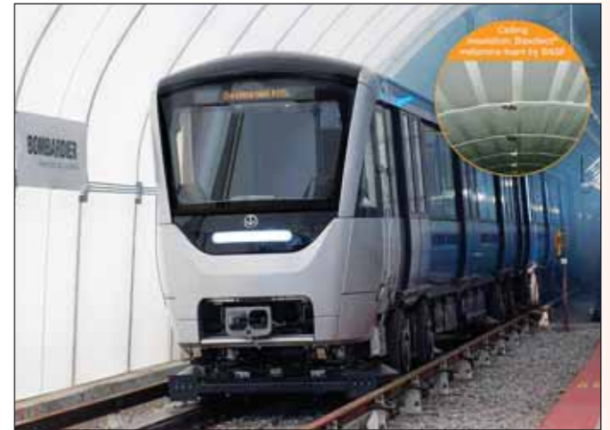
Компания Bombardier использует материал Basotect производства BASF для звуко- и теплоизоляции вагонов метро в Монреале
