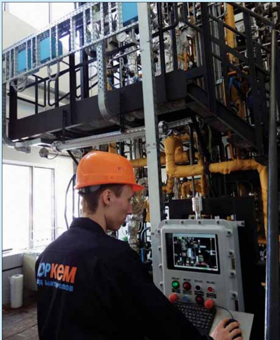
ООО «Завод синтанолов»: пилотная установка для отработки технологий получения продуктов оксигилирования и оксипропилирования с целью их дальнейшего масштабирования на имеющихся производственных мощностях «Норкем»
