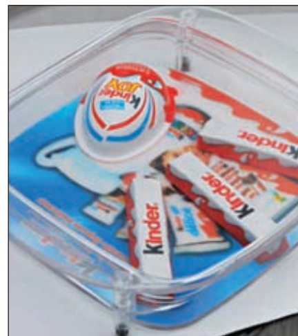
Тарелка для денег, изготовленная из полистирола на ТПА Systec 210–840
