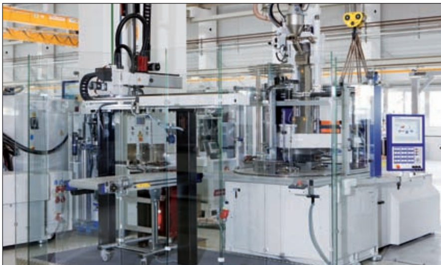
Литьевая машина VM 110/350 R1280 с вертикальным поворотным столом (плитой крепления). Величина усилия смыкания данной литьевой машины составляет 110 тонн, продукт компании Wittmann Battenfeld
