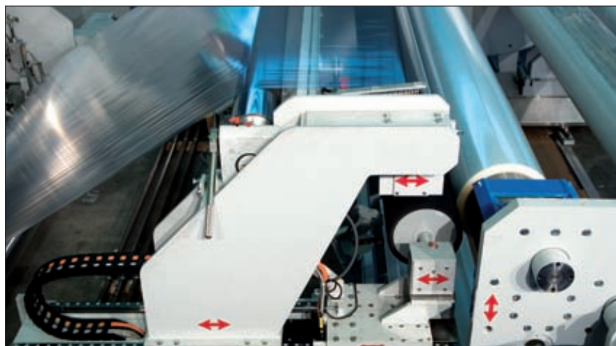
Bruckner Maschinenbau (Германия) представила новые линии для производства БОПП-пленок, которые могут развивать рабочую скорость свыше 525 м/мин
