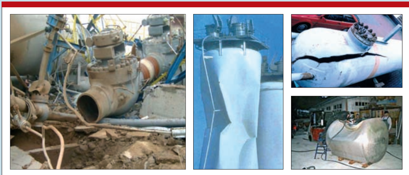
Рис. 4. Последствия работы аппаратов под давлением без предохранительных устройств
