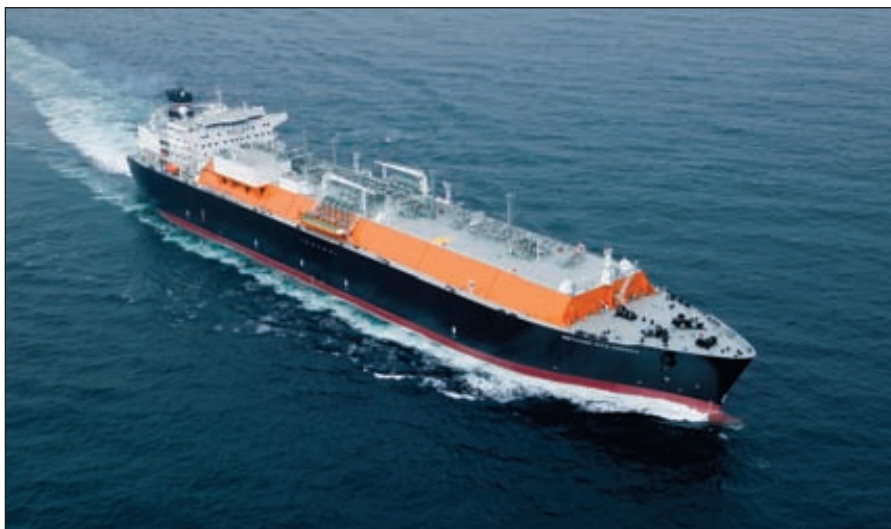
Наличие системы регазификации СПГ (LNG RV) на борту обычного танкера-газовоза дает возможность экспортировать природный газ на новые рынки, которые не имеют береговых приемных терминалов СПГ
