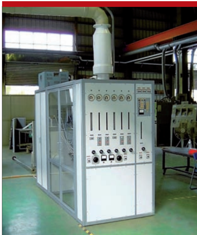
Рис. 4. Микроволновая плазмохимическая установка для получения нанопорошков
