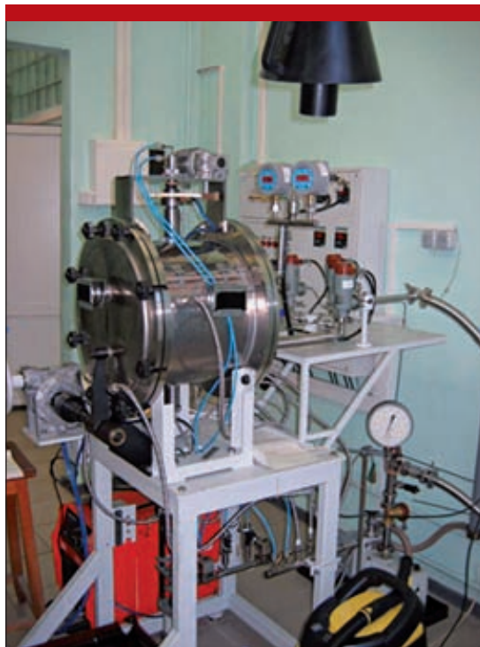
Рис. 5. Автоматизированная установка электродугового синтеза углеродных нанотрубок научно-производственного комплекса ИПХФ РАН «Углерод – ЧГ»
