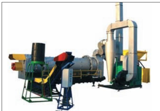
Установка УЗГ-1м для термической утилизации твердых включений нефтешламов  $\geq 2$  мм и замазученного грунта
