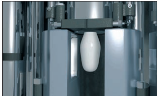
Amcor и Sacmi разработали первую машину компрессионно-выдувного формования из ПЭНД для производства фармаупаковки
