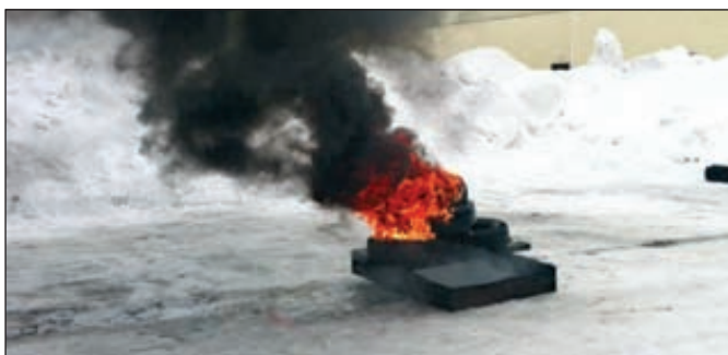
Испытания показывают, что огнетушащие растворы с добавкой гидрогеля «ГП-1» позволяют в несколько раз повысить эффективность тушения пожаров
