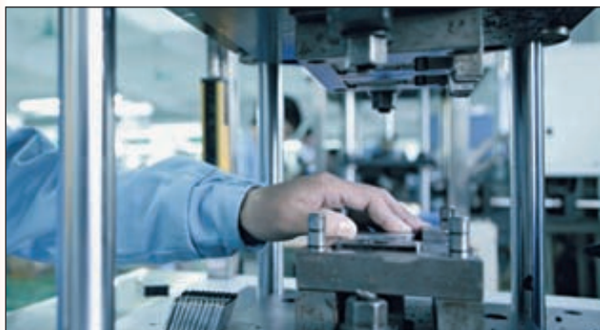
Пресс для получения пластиковых изделий методом литья под давлением
