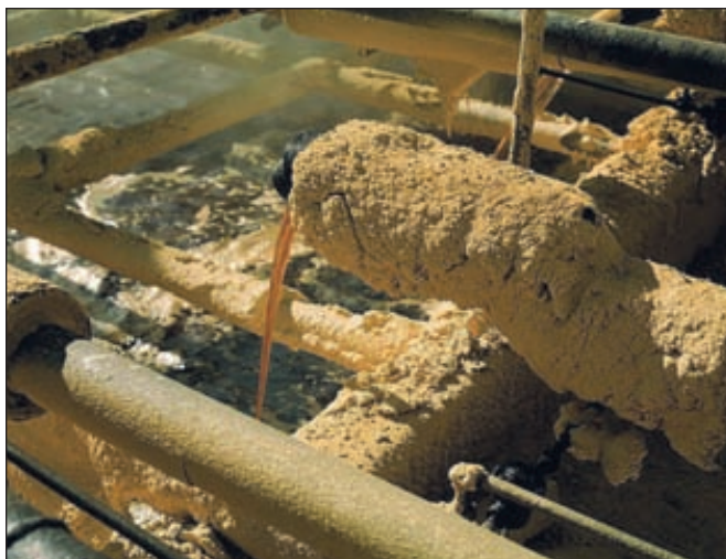
Расплавленная сера из скважины на заводе в Хоскинс Маунд компании Freeport Sulphur, Техас (США). Благодаря методу подземной выплавки самородной серы, разработанному в 1890 году Германом Фрашем, США быстро выдвинулись в мировые лидеры в сфере производства серы
