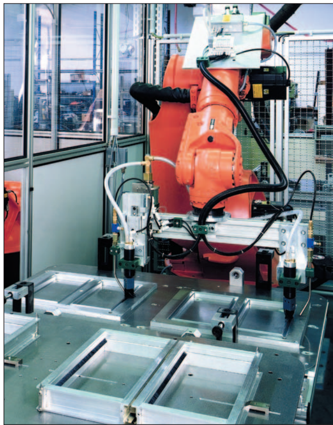
Вращающимися щетками роботы удаляют из форм остатки материала
