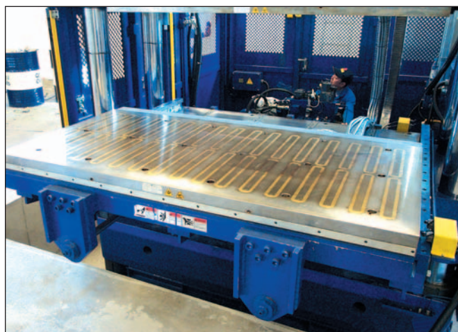
M-Tecs 210 на вертикальном прессе. Плиты величиной 2 000 x 1 000 мм удерживаются силой магнитного притяжения в 1 600 кН; время смены пресс-форм составляет ровно десять минут
