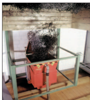
После каждого этапа обработки резанием содержимое накопителя через пневматически управляемый клапан перемещается в большой приемный резервуар
