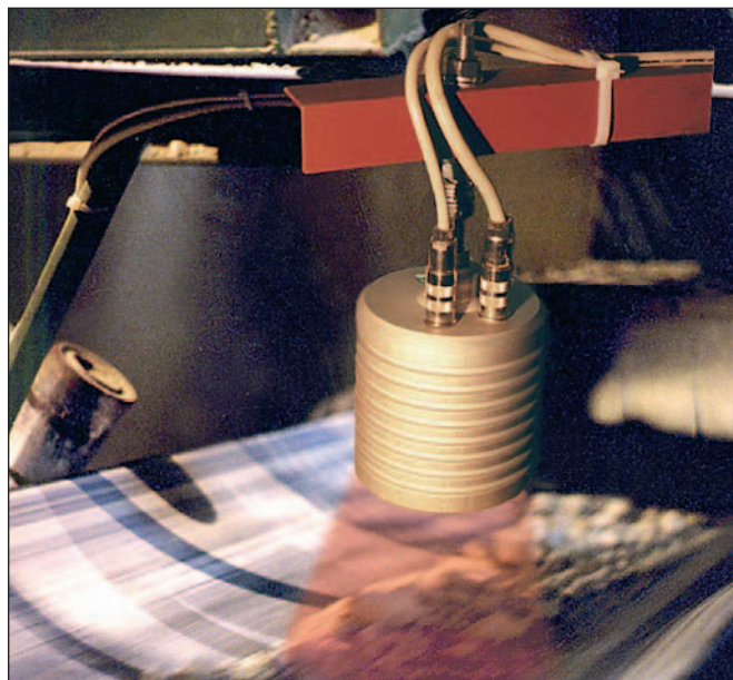
Система измерения влажности, работающая в режиме онлайн над ленточным транспортером
