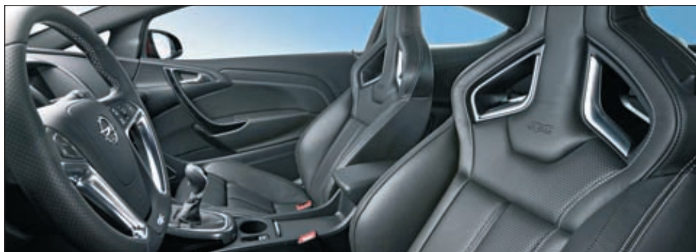
Автомобилестроители начинают применять армированный волокном термопластичный композит на основе продукта Ultramid производства концерна BASF. Чашки сидений в автомобилях Opel Astra OPC стали легче на 45 %
