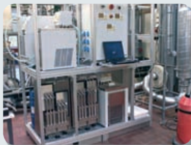
Рис. 8. Пилотные установки для непрерывного проточного синтеза
