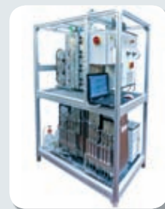
Рис. 8. Пилотные установки для непрерывного проточного синтеза
