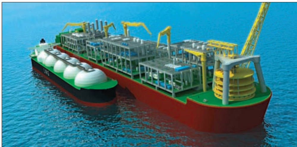
Shell решила построить первый в мире плавучий завод по производству сжиженного природного газа Prelude в 200 км от побережья Австралии. Плавучий завод СПГ будет добывать газ морских месторождений, а затем сжимать на борту судна
