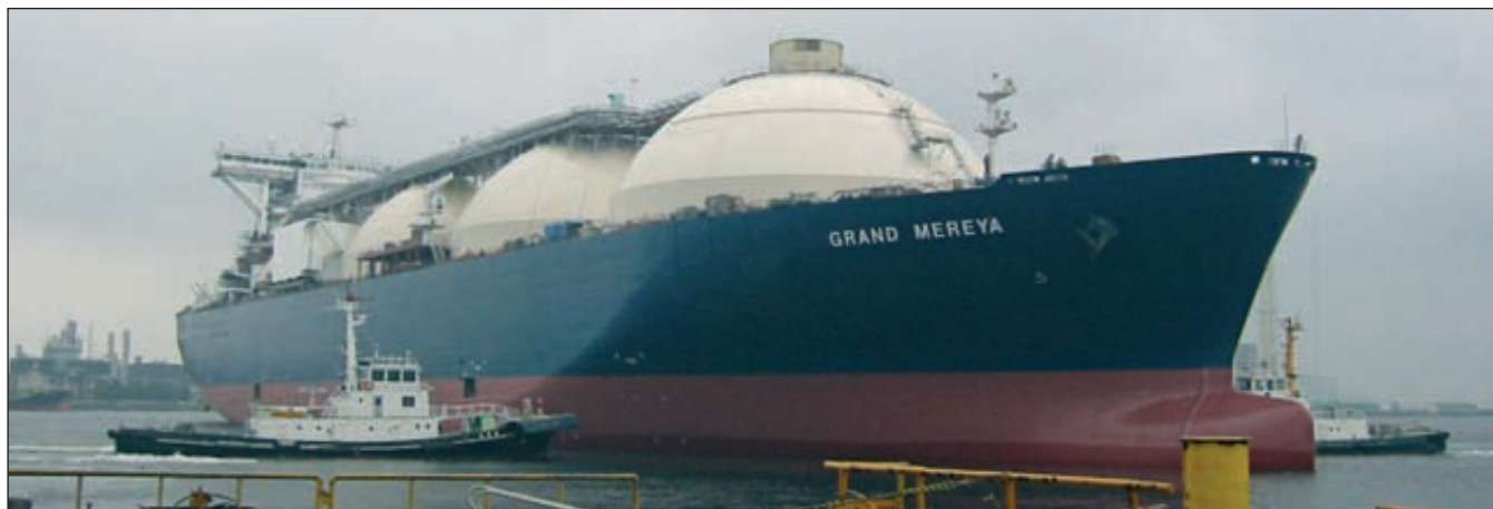
Танкер-газовоз «Гранд Мерья» — был построен в 2008 году на верфях в Тибе, Япония. Этот танкер ледового класса имеет грузоподъемность около 145 тыс. куб. м и разработан для работы в условиях низких температур с целью круглогодичной навигации с Сахалина. Зафрахтован на долгосрочный период компанией «Сахалин Энерджи», оператором крупнейшего нефтегазового проекта «Сахалин-2»
