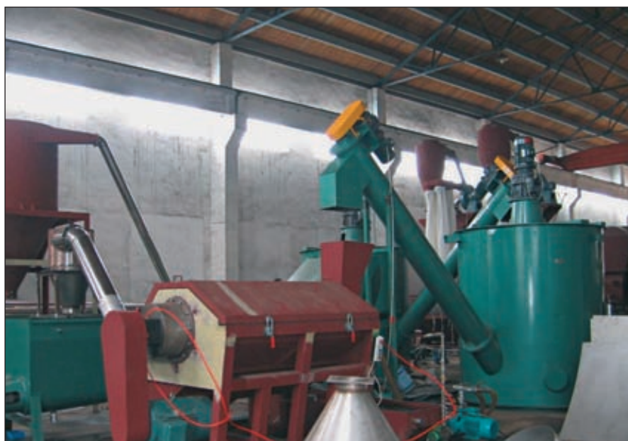
Для получения вторичного ПЭТФ требуемой для пищевой отрасли степени чистоты производитель использует способ отмывки хлопьев горячей водой с последующей термической обработкой в течение 1,5 часов при 120 °С. На фото — производственная линия для отмывки хлопьев
