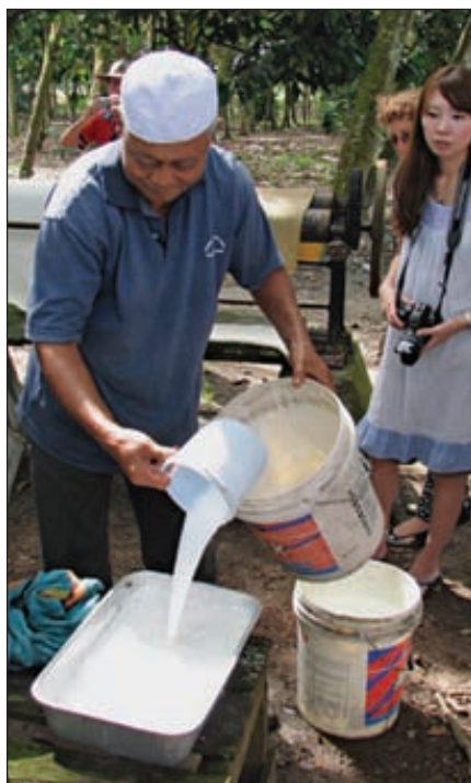
Собранный латекс из каучуковых деревьев заливается в поддон, где отстаивается длительное время. В результате отстаивания сок превращается в плотную и очень прочную резиновую массу. Затем эту массу пропускают через пресс, чтобы отжать воду. В результате получается брикет резины, который затем высушивается при высоких температурах, в результате чего масса приобретает более темный цвет (на фото справа левый брикет)
