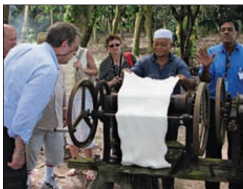
Собранный латекс из каучуковых деревьев заливается в поддон, где отстаивается длительное время. В результате отстаивания сок превращается в плотную и очень прочную резиновую массу. Затем эту массу пропускают через пресс, чтобы отжать воду. В результате получается брикет резины, который затем высушивается при высоких температурах, в результате чего масса приобретает более темный цвет (на фото справа левый брикет)
