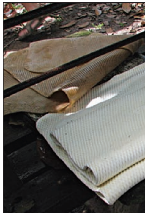
Собранный латекс из каучуковых деревьев заливается в поддон, где отстаивается длительное время. В результате отстаивания сок превращается в плотную и очень прочную резиновую массу. Затем эту массу пропускают через пресс, чтобы отжать воду. В результате получается брикет резины, который затем высушивается при высоких температурах, в результате чего масса приобретает более темный цвет (на фото справа левый брикет)
