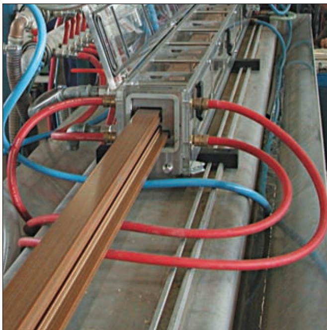
Получение древесно-полимерного композитного профиля методом экструзии на производстве компании SKZ (Германия). В Европе причиной растущего интереса к ДПК является низкая стоимость расходов древесного сырья
