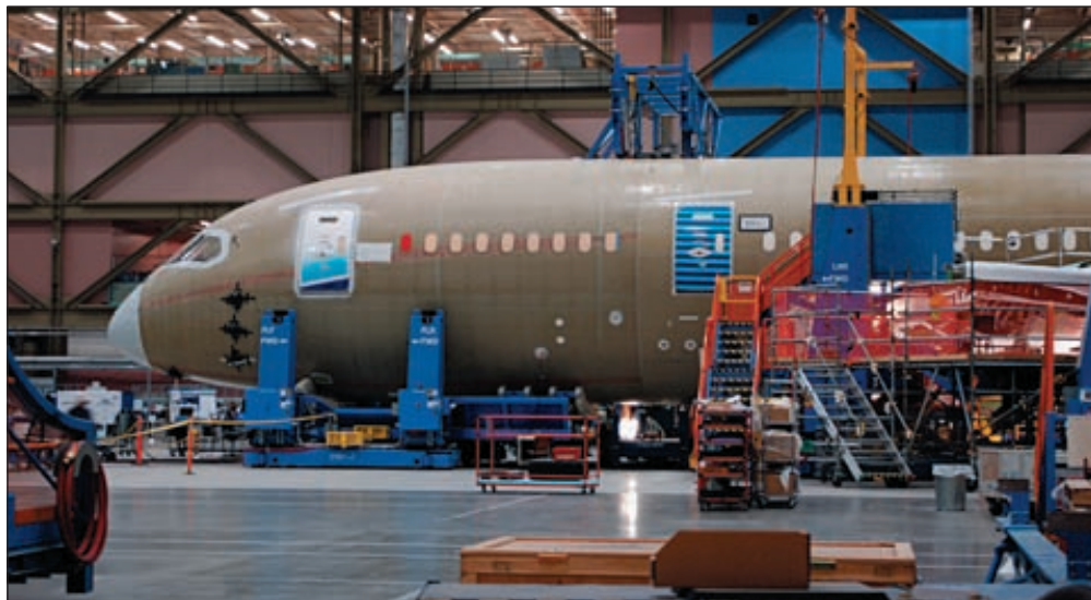
Самолет Boeing 787 Dreamliner в процессе строительства, апрель 2009 года. Фюзеляж из КМ обеспечил возможность увеличения размеров иллюминаторов на 65 %
