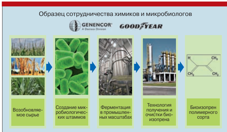
Рис. 1. Схема производства биоизопрена по данным фирмы Danisco
