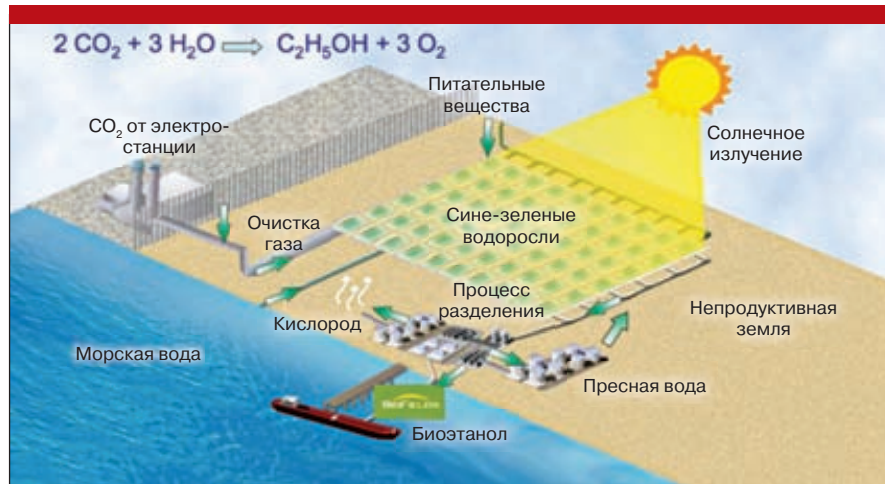
Рис. 7. Схема производства этанола из углеводной части водорослей
