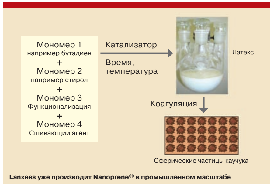
Рис. 2. Производство частиц Nanoprene®
