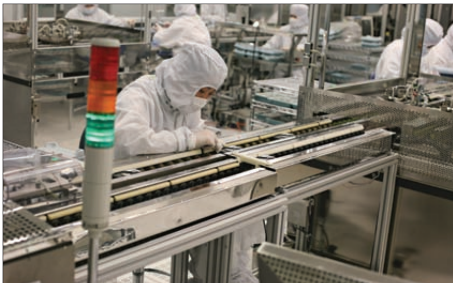
Сборка жестких дисков на 500 Гб для ноутбуков в чистом производственном помещении, Seagate (Китай)
