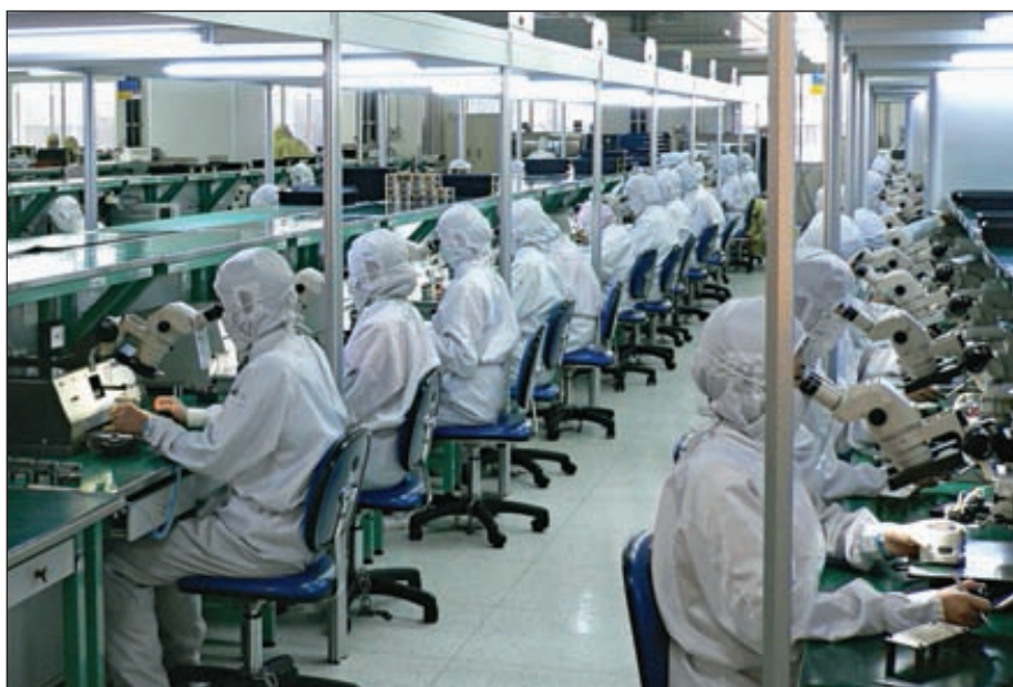
Чистые производственные помещения применяются для различных отраслей промышленности — фармацевтической, медицинской, электронной, пищевой и др. В «чистых комнатах» используется оборудование, выделяющее минимум
