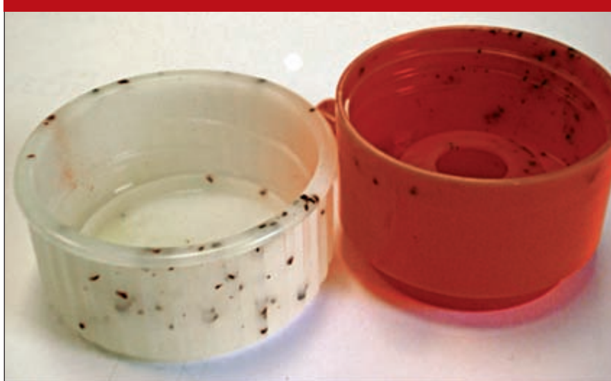
Рис. 9. Дефекты от пыли. Бракованные крышки с черными включениями
