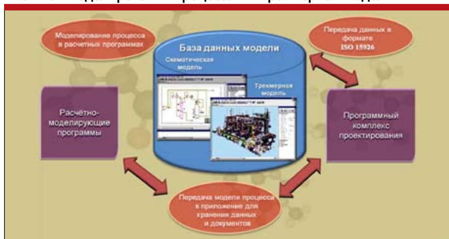
Рис. 4. От моделирования процесса — к трехмерной модели
