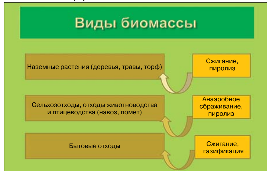
Рис. 4. Способы переработки биомассы
