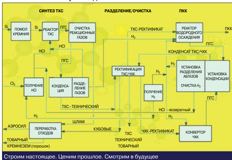
Рис. 2. Блок-схема производств ТХС-ПКК
