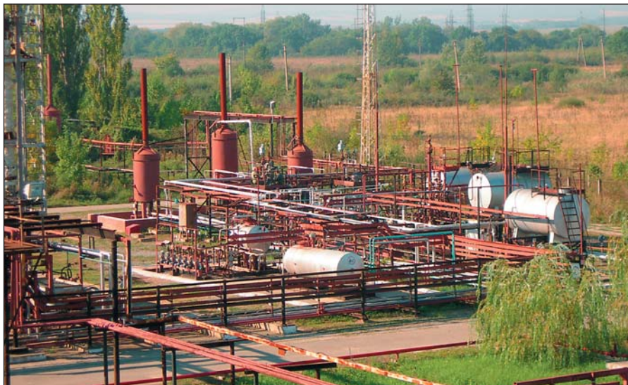
Пилотная установка по выпуску ароматических углеводородов с использованием нефтяного попутного газа, созданная на базе отечественных технологий (г. Краснодар)
