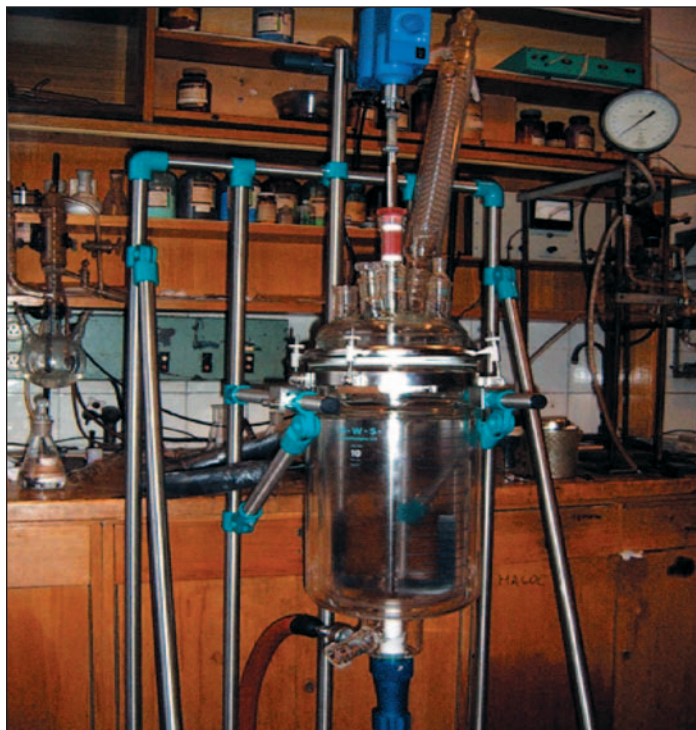
Фото 1. Пилотная установка для синтеза катализатора с рабочим объемом 10 л «в стекле». Производительность — 5 л катализатора в виде суспензии за рабочий день
