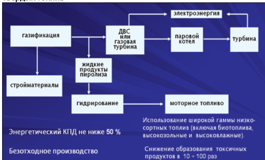
Рис. 1. Комплексное энергохимическое производство на основе твердых топлив
