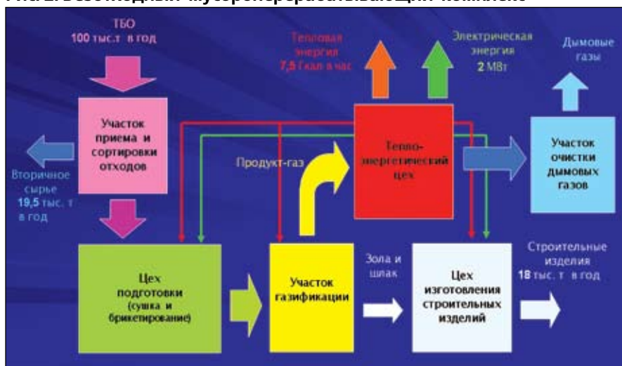
Рис. 2. Безотходный мусороперерабатывающий комплекс
