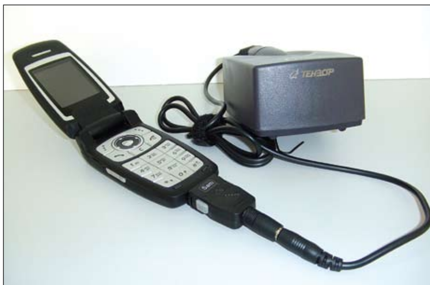
Топливные элементы позволяют заряжать мобильные устройства при отсутствии традиционных источников тока
